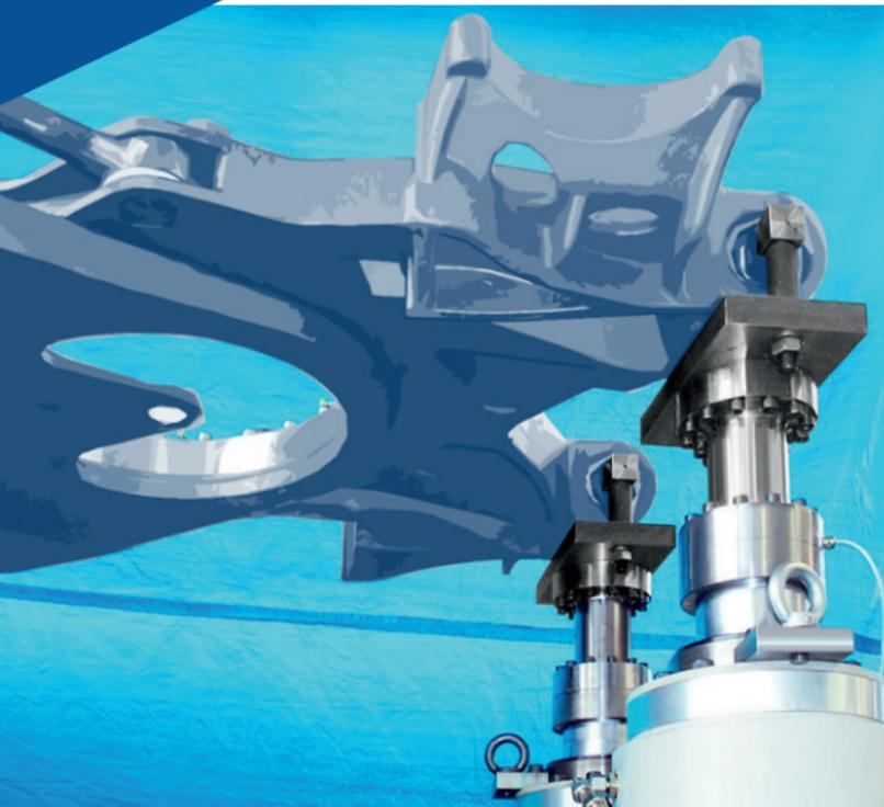
Unsere Lebensdauerversuche mit hydraulischen oder pneumatischen Prüfzylindern decken ein breites Spektrum ab. Der Einsatz gliedert sich kundenspezifisch nach der Anzahl sowie der geforderten Kraft- und Weggröße der Zylinder.
